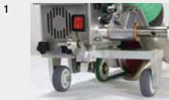
**1** **Se elimina el reequipamiento que provoca grandes pérdidas de tiempo:** La soldadora automática para tejados extraordinariamente estrecha con eje de transporte desplazable permite soldar sin esfuerzo y cerca del borde del ático hasta 100 mm, sobre el ático, en la superficie y en cualquier punto estrecho.
