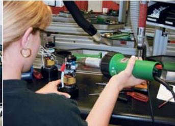
Modelado por vacío y contracción de una manguera retráctil en caliente con TRIAC PID.
