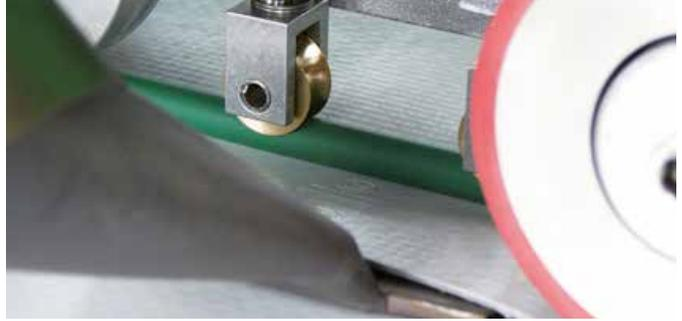
La separación de aire mantiene el aire caliente en la costura de soldadura para una soldadura segura.
