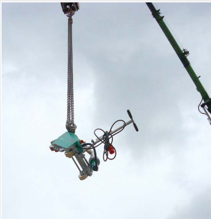
Incluso sin carcasa, se puede izar en un gancho de grúa de forma sencilla hasta el tejado.
