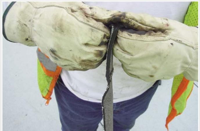
*La prueba de pelado demuestra que la resistencia de la soldadura con la BITUMAT B2 es notablemente mayor que con llama abierta.*
