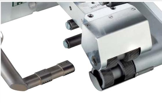
cabo mediante un rodillo de presión especialmente creado para ello con el que cuenta la TWINNY S. Gracias a él, se obtienen dos cordones de soldadura paralelos de 15 mm cada uno. El canal de prueba que se crea entre ellos tiene una abertura de 20 mm. Con él puede comprobarse la impermeabilidad mediante aire comprimido.
