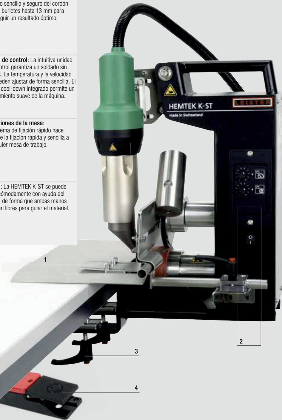
al pedal, tendrá las dos manos libres y podrá utilizarlas para guiar el material. De forma que se concentrará por completo en el proceso de soldadura.
