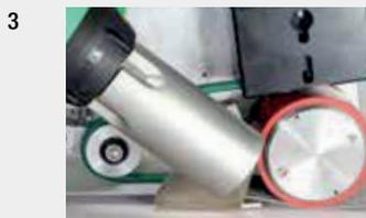
**3** **UNIROOF AT:** El sistema **Closed-loop** totalmente regulado para el accionamiento, la temperatura y la cantidad de aire del soplador mantiene los parámetros de soldadura constantes, permite una soldadura fiable en cuanto a la estanqueidad y garantiza seguridad de procesos e inversiones para constructores y promotores.
