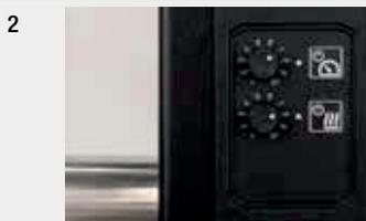
**Panel de control:** La intuitiva unidad de control garantiza un soldado sin estrés. La temperatura y la velocidad se pueden ajustar de forma sencilla. El modo cool-down integrado permite un enfriamiento suave de la máquina.
