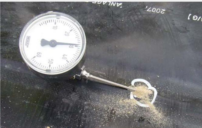
Con la aguja de inyección se comprueba la estanqueidad de la (inmejorable) soldadura.
