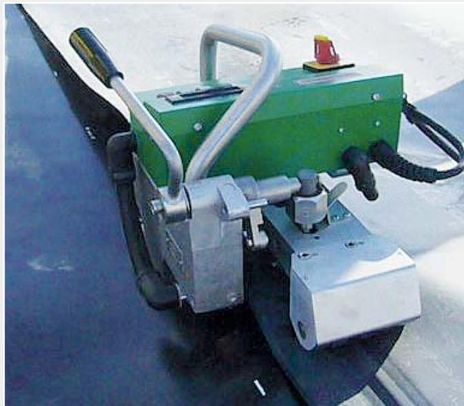
*La ASTRO suelda las membranas impermeabilizantes de PEAD con una velocidad de hasta 5 m/min.*
