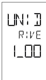
Después de conectarlo, en la pantalla de la **unidad de manejo (3)** se muestra por unos instantes la **pantalla de inicio** con el número de versión del software y la denominación del equipo.
