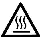
**Atención:** ejecute completamente el modo Cool-down para que, durante el cambio de rodillos, no se produzcan combustiones debido a contactos involuntarios de componentes calientes.
