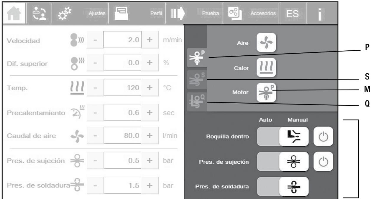
Para cambiar entre los diferentes brazos, coloque todos los ajustes a manual y off. Ahora, los **rodillos de transporte (9)** están abiertos y la **tobera de soldadura (12)** se encuentra en posición inicial.
