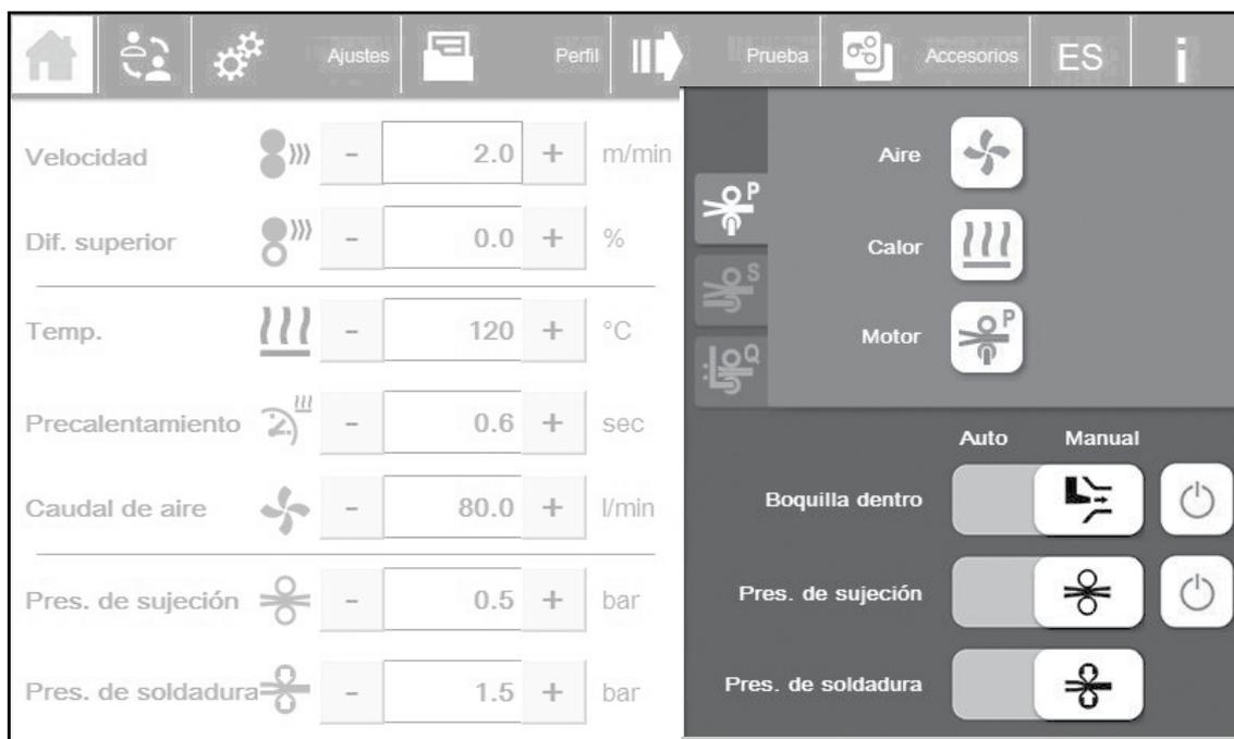
Para cambiar los **rodillos de transporte (9)**, deje enfriar la máquina con el modo Cool-down. Ajuste los periféricos TOBERA, PRESIÓN DE AGARRE y PRESIÓN DE SOLDADURA al modo manual. Ajustando el motor a "ON", el cambio será más sencillo.
