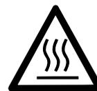
**Peligro:** la **tobera de soldadura (12)**, el tubo del elemento térmico y el **tubo de protección de elemento térmico (24)** se calientan mucho durante el funcionamiento. Existe riesgo de quemadura al entrar en contacto con dichos elementos. Nunca toque ninguno de estos componentes mientras la máquina esté en funcionamiento. Los elementos todavía pueden estar calientes tras el modo Cool-down.
