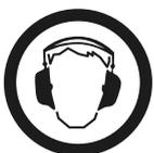
En función de la configuración de la máquina (ancho de toberas, ajuste de toberas, caudal de aire) y el material de soldadura utilizado, la máquina puede alcanzar un nivel de sonido muy elevado. Tanto usted como las personas del entorno deben llevar la protección auditiva adecuada.
