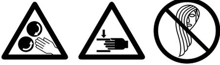
**Peligro:** no introduzca la mano entre los componentes móviles, por ejemplo, entre los **rodillos de transporte (9)**. En caso de realizar trabajos en el sistema abierto, no llevar prendas como bufandas, pañuelos o corbatas y recoger el pelo o protegerlo mediante un gorro o similares.
