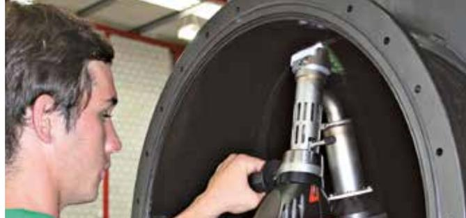
Simple auto-soldadura de radios interno.
