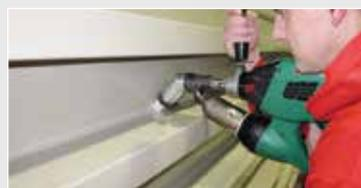
Facilita la soldadura en posiciones difíciles: la tobera angulada de 45° de WELDPLAST S2. (accesorio)
